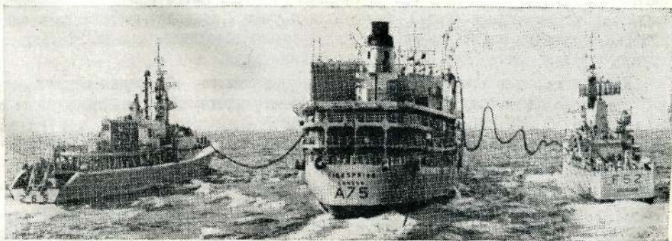
Рис. 2. Пополнение запасов топлива в море кораблями постоянного соединения ВМС НАТО на Атлантике
